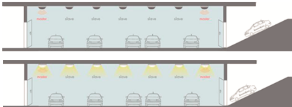
Mejora de usos y costumbres en iluminación sensorizando el parking con sistemas RF
